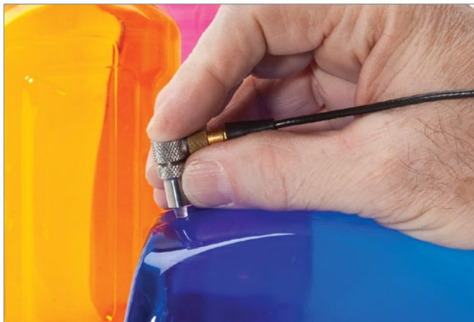
Измерение тонких пластиковых материалов с использованием преобразователя с линией задержки и частотой 20 МГц.
