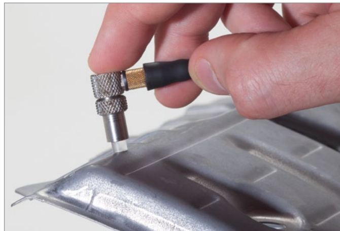
Измерение утонения металла после формования.
