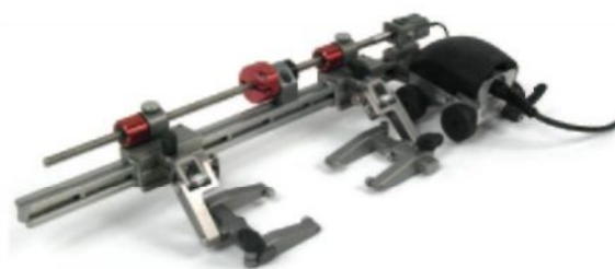
Оptionальный комплект магнитных колес позволяет использовать цепной сканер в качестве "Mouse" сканера.
