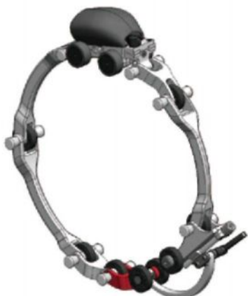
Система позиционирования датчика за счет ходовых винтов
